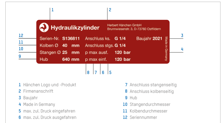
Abbildung 1: Beispiel Typenschild Hydraulikzylinder
