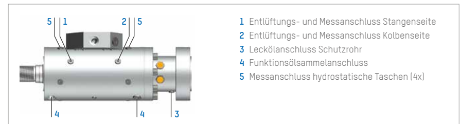
Abbildung 7: Entlüftungs- und Messanschlüsse Zylinder Dichtungssystem Servobear®
